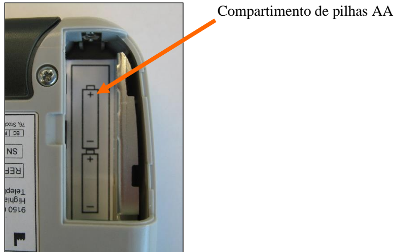
Figura 3: Gravador de dados ZepHr – Vista traseira com tampa do compartimento de pilhas aberta
